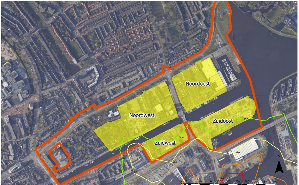
Afbeelding 5.5: Geluidbelasting industrielawaai Wet geluidhinder na verplaatsen activiteiten VHR, Industrieterrein Groningen Zuidoost (2013)
