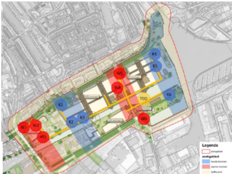
Afbeelding 2.10: Schematische weergave warmte- en koudebronnen (bron: scenariostudie energie RHDHV)
